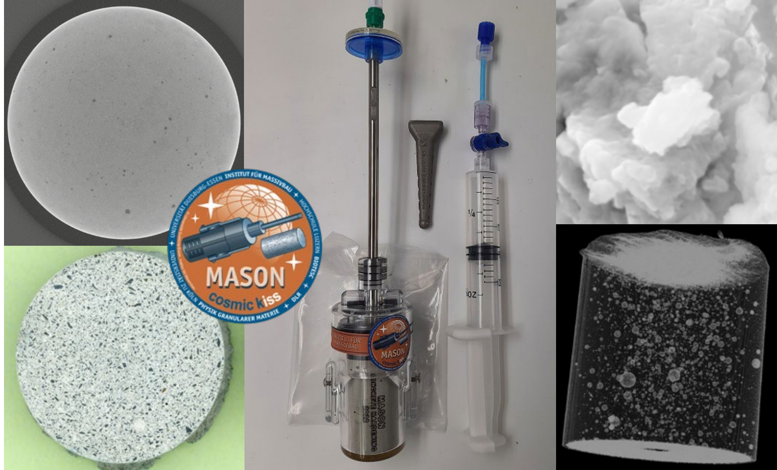
Slice CT-Scan (oben links), Querschnitt Regolith-Beton (unten links), MASON Logo (Mitte links), MASON Concrete Mixer Kit (Mitte), REM Aufnahme Zementpartikel (oben rechts), CT-Scan eines Zylinders (unten rechts)
