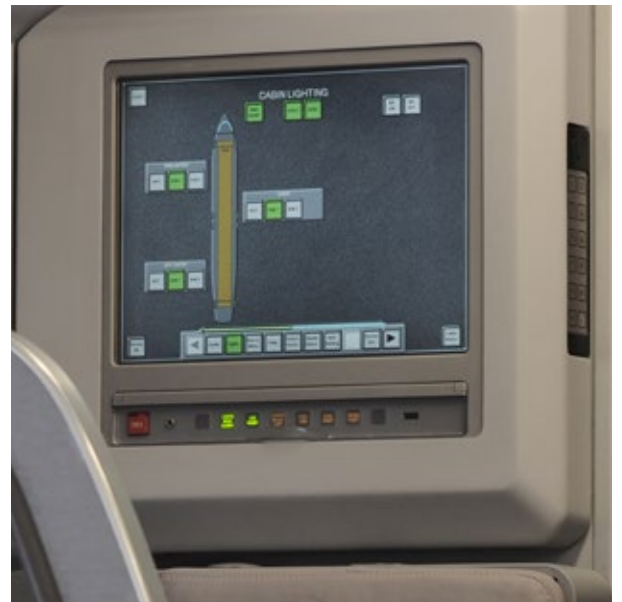
FAP A320 - Prozesssicher gefertigtes Leichtbaugehäuse
