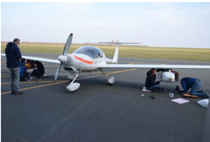
Das Forschungsflugzeug (Motorseglers) der Jade-Hochschule Wilhelmshaven beim Einbau des MAMAP2DL-Sensors im Außenlastbehälter unter dem Flügel. Damit wurde im Jahr 2021 das Braunkohlekraftwerk in Jänschwalde überflogen und dessen Emissionen gemessen. © Universität Bremen, Institut für Umweltphysik.
